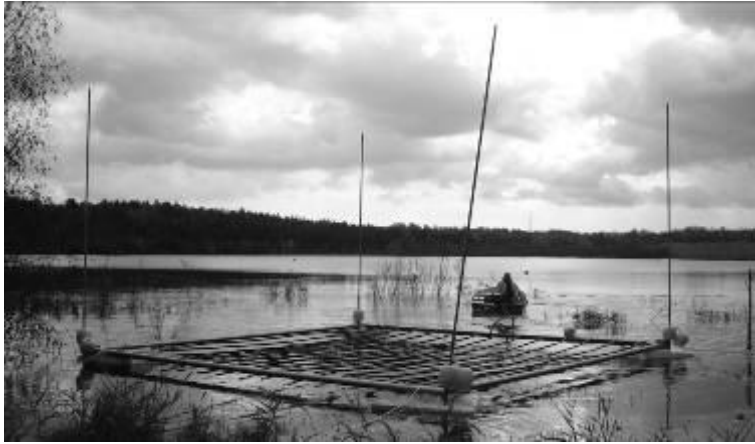
Abbildung 6: \text{CO}_2 - Verteilung im Seekörper über Begasungsrahmen, Beaufschlagung über Verteilleitung
